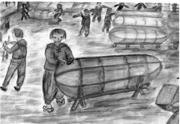
カワイ楽器のピアノ工場で作られていた「落下タンク」（ガソリンを入れるタンク）。鉄が不足し、骨組みもベニヤ板で、表は布地を貼った（小島節子さん絵・談※）
